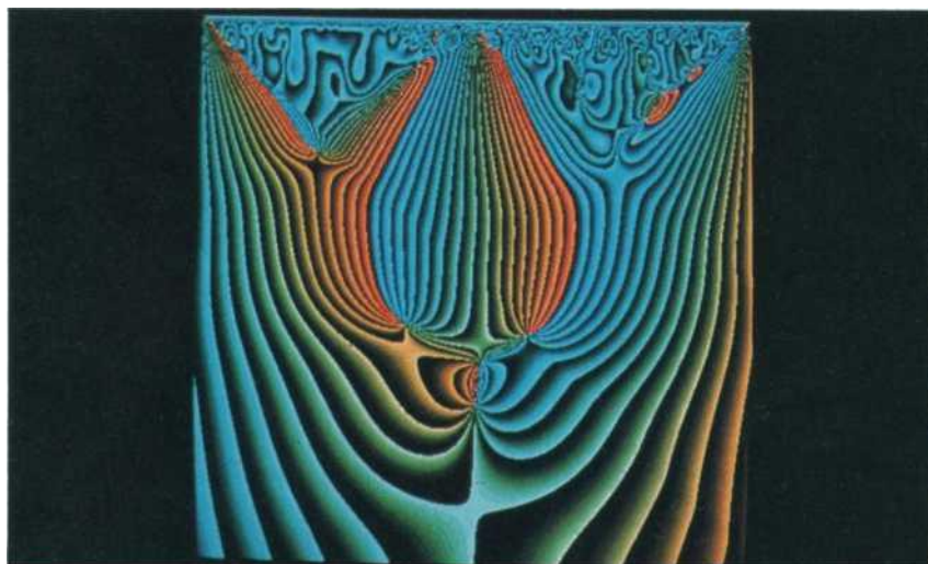
Transformée en ondelettes d'un signal turbulent. (Collaboration J.-F. Colonna, LACTAMME et M. Holschneider, Centre de physique théorique © CNRS-LMD-M.Farge-J.-F. Colonna).
