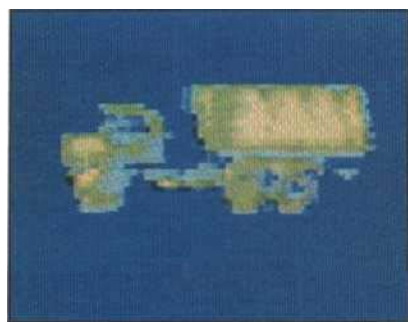
Reconnaissance de forme par traitement du signal infrarouge au cours d'une observation nocturne. (©SAT).
