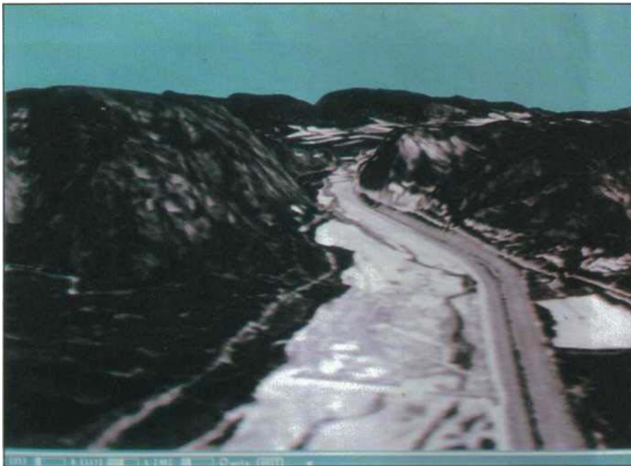
Fig. 2 - Vue perspective obtenue en « habillant » le MNT par les pixels de l'image SPOT.
