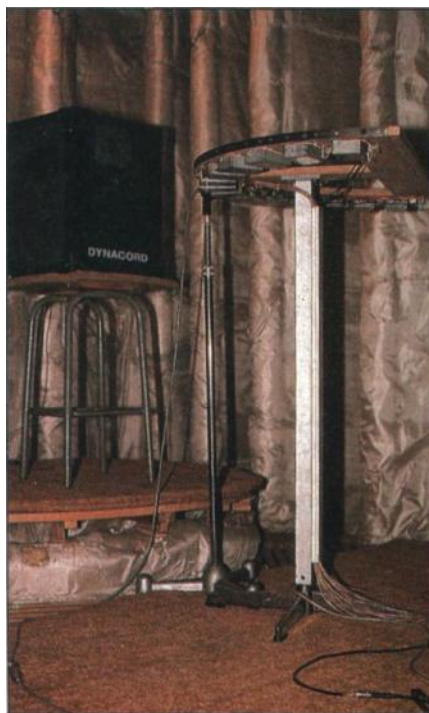
Mesure en chambre sourde d'une antenne à 15 microphones,
