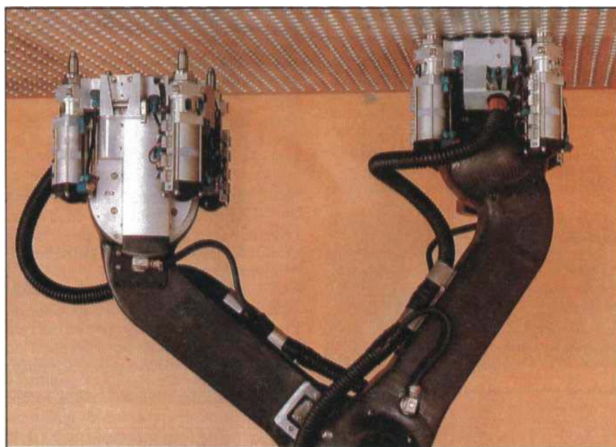
Le nouveau robot RITMIC déplace les porte-sondes sous la plaque tubulaire du générateur de vapeur; la sonde à courants de Foucault est envoyée dans chaque tube. (Cliché Intercontrôle).
