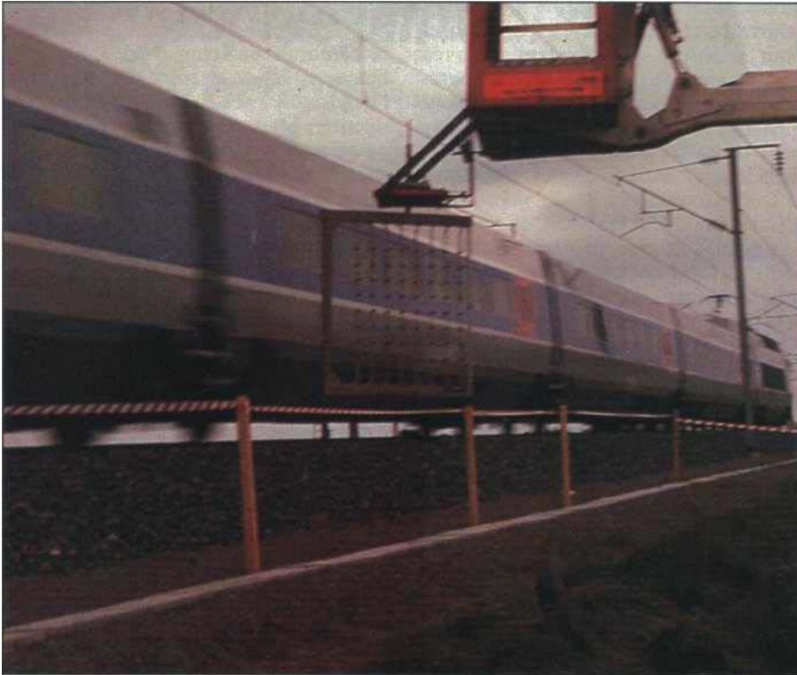
Fig. 2 - Mesure à l'aide d'une antenne acoustique du bruit émis par le TGV.
