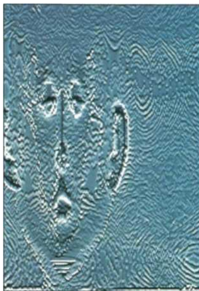
Représentation des courbures maximales estimées sur une forme tridimensionnelle échantillonnée par un système de triangulation active. L'objet (un buste de femme) est représenté sous la forme d'une image de profondeur en coordonnées cylindriques. (Cliché H. Maître, Telecom Paris).
