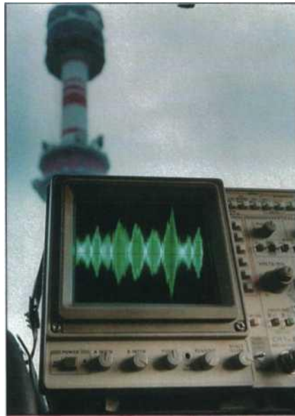
La propagation par trajets multiples génère une sélectivité de la transmission dans le domaine fréquentiel : l'enveloppe du signal représenté sur l'oscillogramme correspond à la réponse en fréquences du canal, mesurée sur une bande de 4 Mhz à la fréquence porteuse de 794 Mhz.
