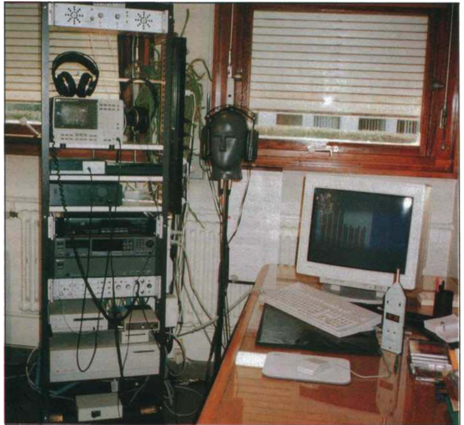
Appareillage servant à étudier la restitution, en chambre sourde, de la sensation d'espace sonore.
